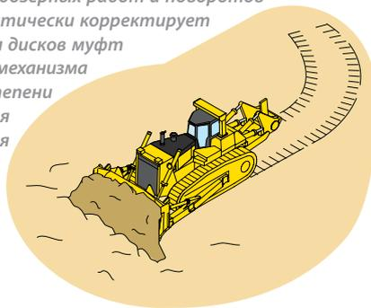
При выполнении бульдозерных работ под уклон клапан ECMV осуществляет автоматическое управление муфтами и тормозами рулевого механизма в соответствии с углом наклона машины или степенью нагрузки, сокращая операции по корректировке направления движения и обеспечивая плавное выполнение работ.
