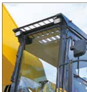
Стеклоочиститель, смонтированный на раме кабины
