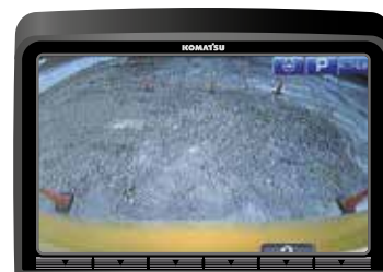
Изображение с камеры заднего вида на дисплее
