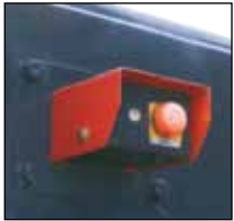
Выключатель аварийной остановки двигателя (с функцией блокировки пускового переключателя двигателя)
