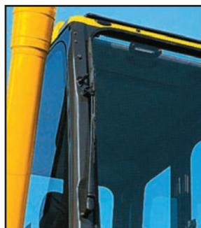
Стеклоочиститель, смонтированный на раме кабины
