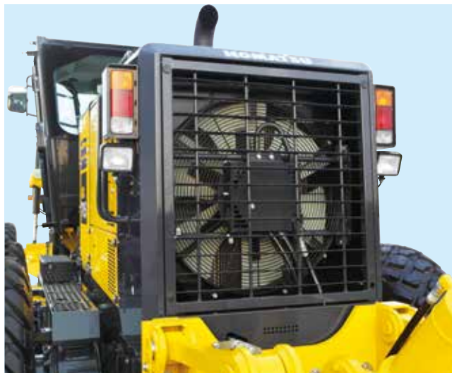
Работающий от гидропривода вентилятор радиатора
