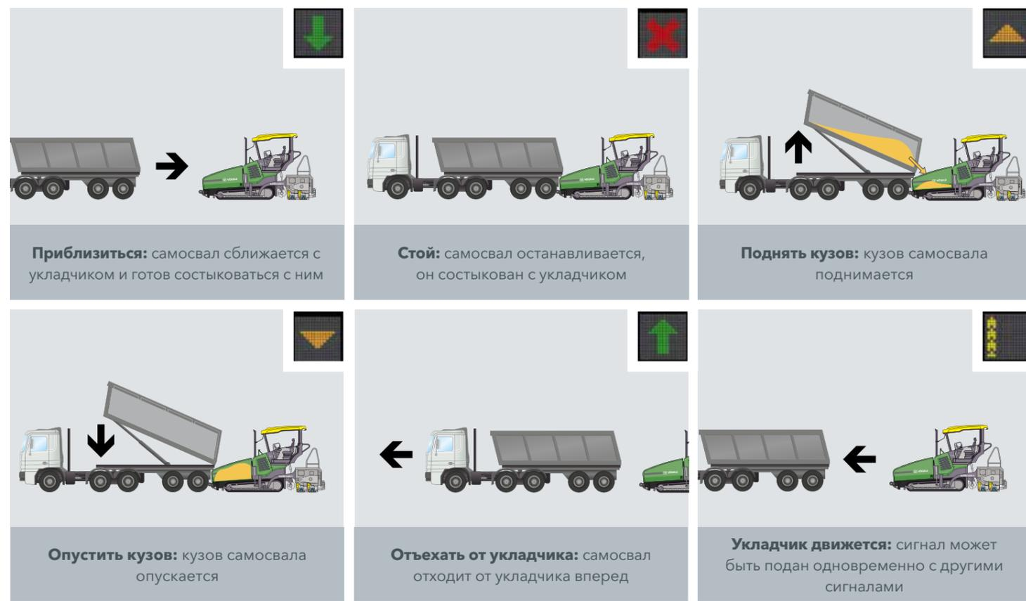
**Функция PaveDock Assistant** способствует коммуникации между водителем самосвала и машинистом укладчика, что ускоряет выгрузку смеси в бункер укладчика и делает её более точной. Основными компонентами являются светофор на крыше укладчика и соответствующие органы управления на пульте машиниста ErgoPlus 3.
