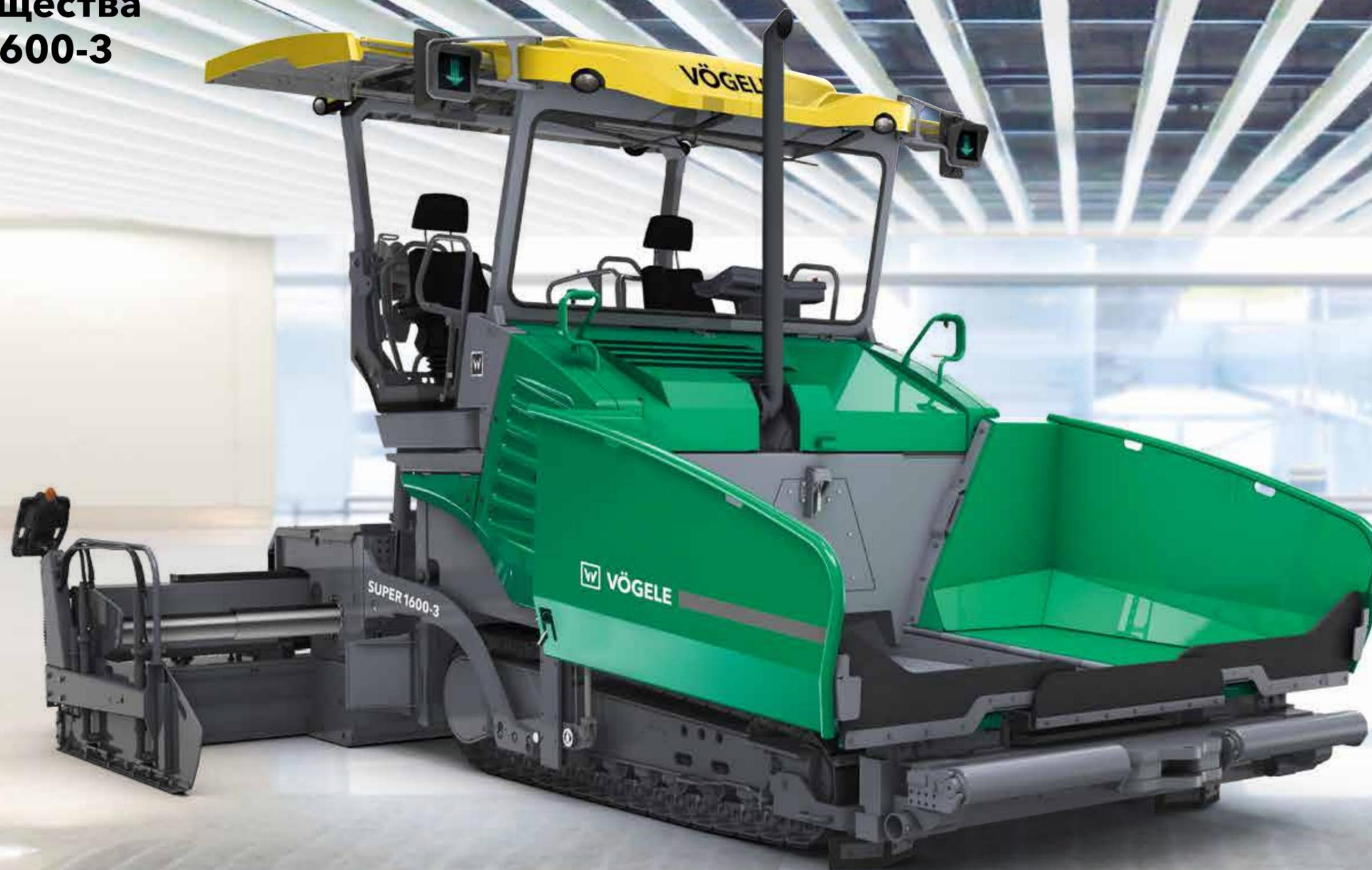
**Гусеничный асфальтоукладчик класса Universal Class** с широким спектром применения при ширине укладки до 7,5 м.\*
