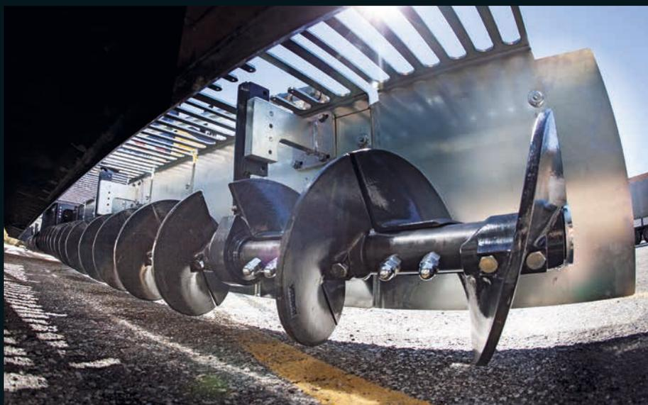
Оптимальное распределение материала: большой диаметр шнека.
