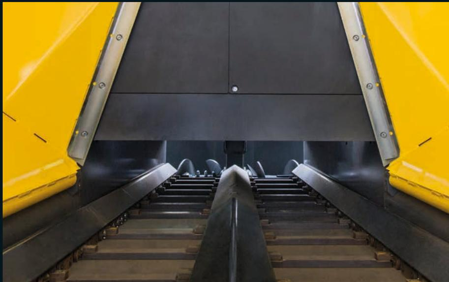
Подача материала без помех: реверсивный скребково-ленточный конвейер.
