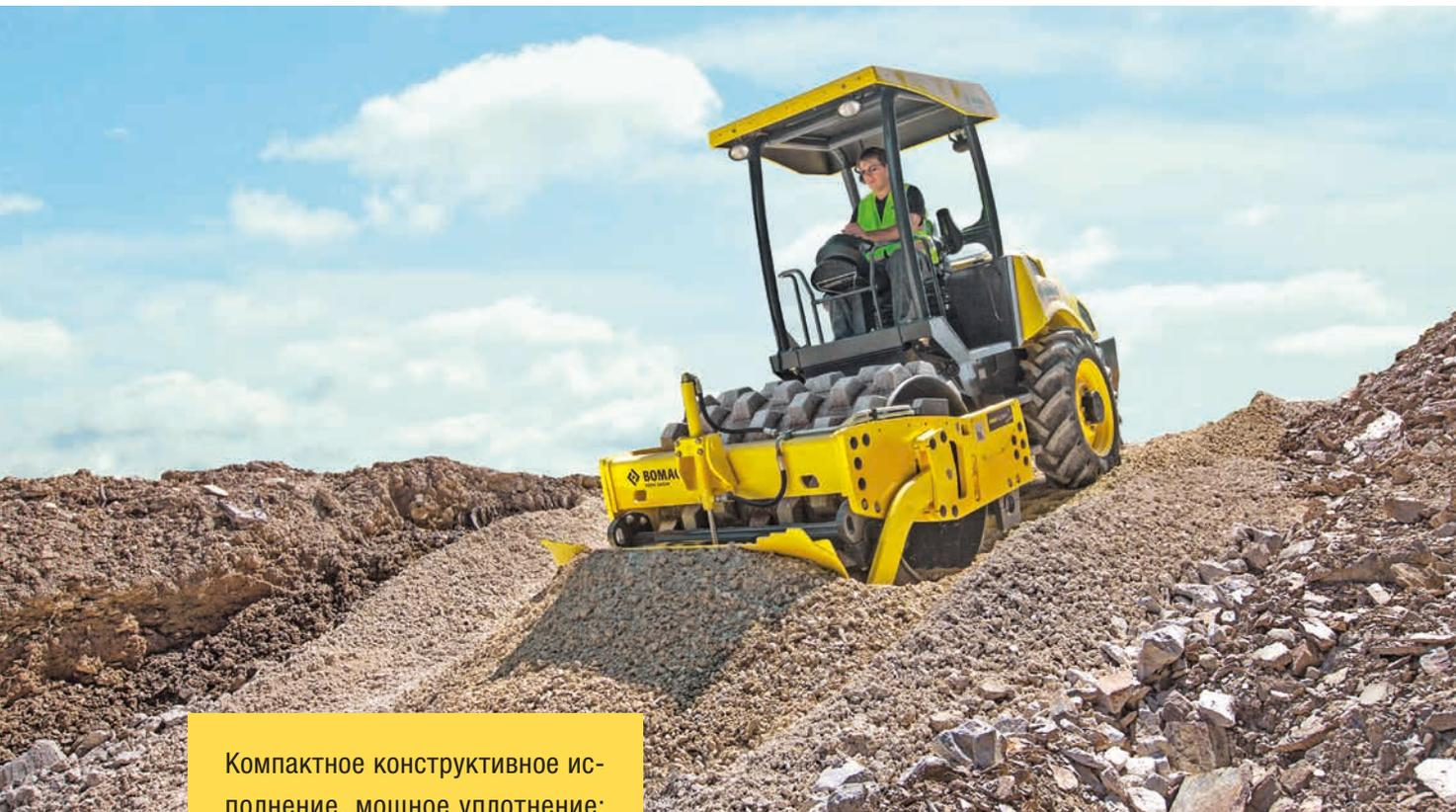
Компактное конструктивное исполнение, мощное уплотнение: Небольшие размеры и великолепная маневренность в сочетании с мощным уплотнением делают грунтовые катки превосходными помощниками на стройплощадке в центральной черте города.
