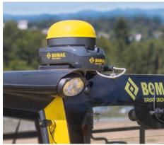
BOMAG StarFire: точность посредством GPS
