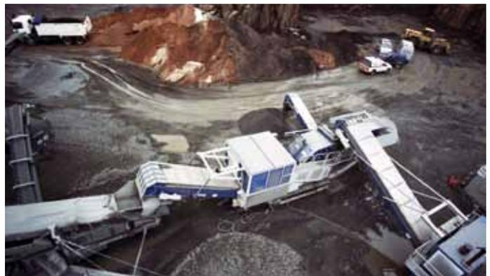
Kleemann MOBIFOX MF 14 при переработке известняка.
