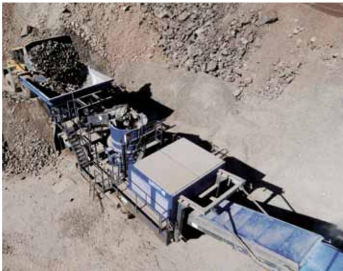
Установка MCO 11 может загружаться колесным погрузчиком.
