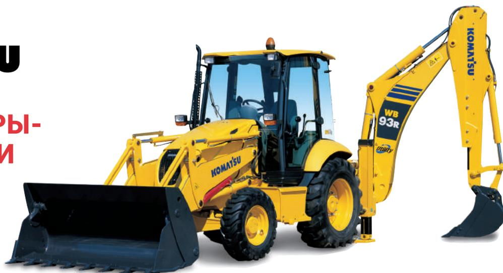
**ЭКСКАВАТОР-ПОГРУЗЧИК WB93R-5E0** — производительная и удобная в эксплуатации машина грузоподъемностью 5,3 т. Гидравлическая система с закрытым центром (CLSS) благодаря регулируемому потоку масла эффективно использует мощность двигателя, а наличие двух рабочих режимов позволяет опе-
