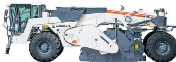
**РЕСАЙКЛЕРЫ** — основа технологического процесса реконструкции дорожного покрытия. Холодные ресайклеры и стабилизаторы грунта WIRTGEN обеспечивают максимальную производительность и первоклассное качество смеси независимо от рабочей глубины. Машины выпускаются в колесном и гусеничном исполнении.
