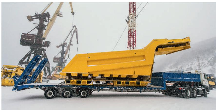
730E-8 — высоконадежная машина, обеспечивающая бесперебойную работу даже в тяжелых условиях. Конструкция рамы значительно усовершенствована. В наиболее нагруженных зонах, включая места крепления кузова и элементы кольцевого сегмента рамы, применены литые детали. Несмотря на габариты, радиус поворота 730E-8 (13,6 м) позволяет выполнять погрузочно-разгрузочные работы в стесненных условиях.
