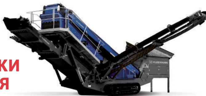
При использовании технологии холодного ресайклинга на заводе дорожное покрытие, снятое фрезой, предварительно подвергают дополнительной сортировке с помощью мобильных установок для грохочения. На переработку в дробилки или гранулятор направляют только фракции избыточной крупности. Такой подход позволяет значительно сократить производственные расходы по сравнению с полноценной переработкой всего поступающего объема асфальтобетонной крошки.
