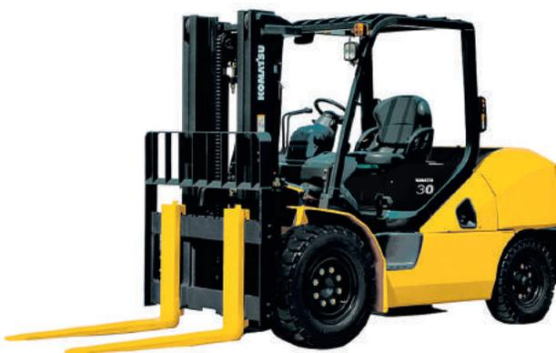
**ВИЛОЧНЫЕ ПОГРУЗЧИКИ СЕРИИ AX50/VX50** — дизельные и бензиновые вилочные погрузчики грузоподъемностью до 3,5 т. Высокоманевренные и экономичные машины для работы на высоте до 3 м, незаменимые
