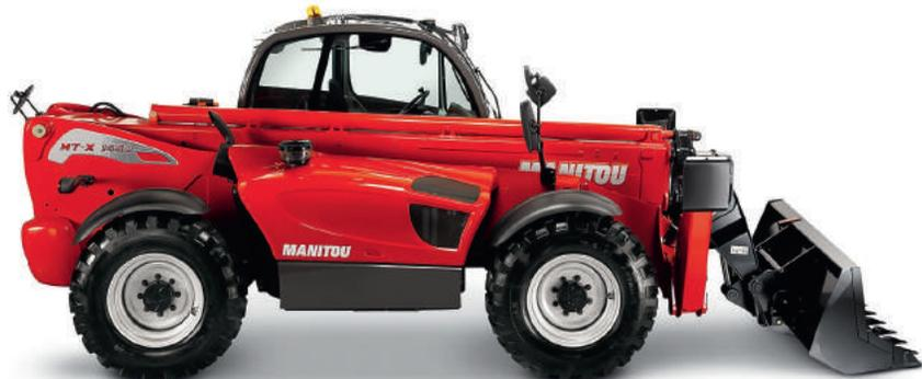
**ТЕЛЕСКОПИЧЕСКИЙ ПОДЪЕМНИК МТ-Х 1440** рассчитан для работы на строительных и производственных площадках, где требуется подъем грузов на большую высоту. Максимальная высота составляет почти 14 метров, а грузоподъемность — 4 тонны. Большие выносные опоры обеспечивают великолепную боковую и переднюю устойчивость машины. МТ-Х 1440 подходит для работы на любых типах грунта благодаря четырем ведущим и направляющим колесам, а также высокому дорожному просвету.
