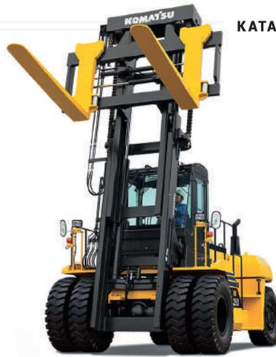
**ВИЛОЧНЫЕ ПОГРУЗЧИКИ FD 200/250-7** — самые мощные и производительные дизельные вилочные погрузчики Komatsu. В моделях установлен 6-цилиндровый двигатель Komatsu SAA6D107E-1 объемом 6,7 л, который
