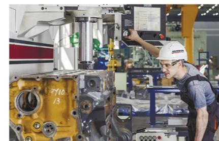
Высокопроизводительный станок для обработки привалочных плоскостей, контурного фрезерования, расточки цилиндров и восстановления постели коленвала. Заменяет четыре станка и обеспечивает точность обработки деталей до 0,005 мм. Замена инструментов и трансформация станка из расточного в шлифовальный занимает менее 15 секунд.
