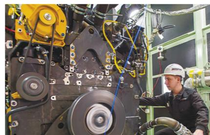
Разработанный специально для центра «Реман» стенд для обкатки двигателей внутреннего сгорания. Позволяет тестировать двигатели под различными видами нагрузки, максимально приближенными к реальным. В случае если двигатель не проходит тестирование, сотрудники центра «Реман» выявляют причину, устраняют неисправность и снова обкатывают компонент.
