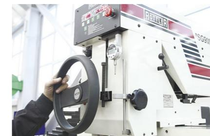
Высокоточный полуавтоматический станок для машинной обработки седел клапана и направляющих втулок головки блока цилиндра. Производительность на 30–50% выше, чем при обработке деталей шлифовальными инструментами и станками с ручным управлением. Точность обработки до 0,002 мм.
