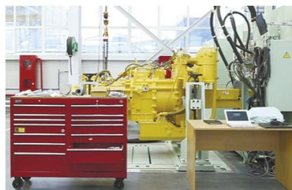
Первый в мире универсальный стенд, позволяющий тестировать несколько видов гидравлического оборудования (трансмиссии, гидравлические насосы, электромоторы). Стенд произведен специально для магаданского центра «Реман» в Японии в 2016 году. Может осуществлять испытания компонентов под различной нагрузкой в течение 72 часов без перерыва.
