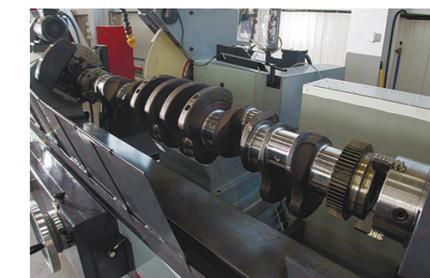
Автоматизирован за счет числового программного управления, поперечной подачи абразивного круга — менее 0,004 мм, что сводит к минимуму участие оператора.
