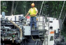
1-2 | Изменение положения приборных панелей, по направлению движения машины, обеспечивает оптимальное управление 3800 CR во время ресайклинга с задним конвейером и при использовании в качестве холодной фрезы.
