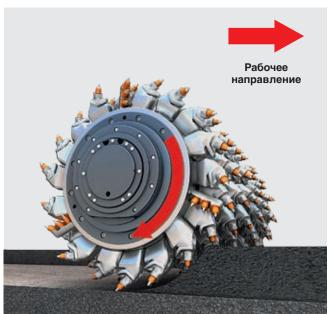
Фрезерование с движением резцов вниз: Фрезерно-смесительный барабан работает по направлению движения ресайклера. Данный процесс оптимизирует размер частиц и предотвращает разбивку материала на более крупные куски.
