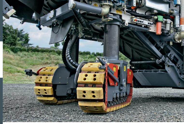
Гидравлическая система рулевого управления обеспечивает большие углы поворота всех четырех гусеничных тележек.
