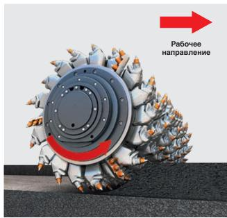
Фрезерование с движением резцов вверх: Фрезерно-смесительный барабан работает в направлении, противоположном движению ресайклера.
