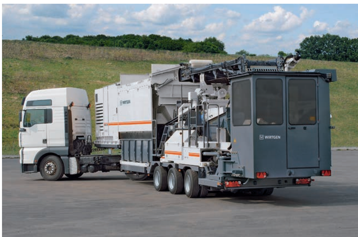
Перевозка установки осуществляется стандартным автотракторным транспортом
