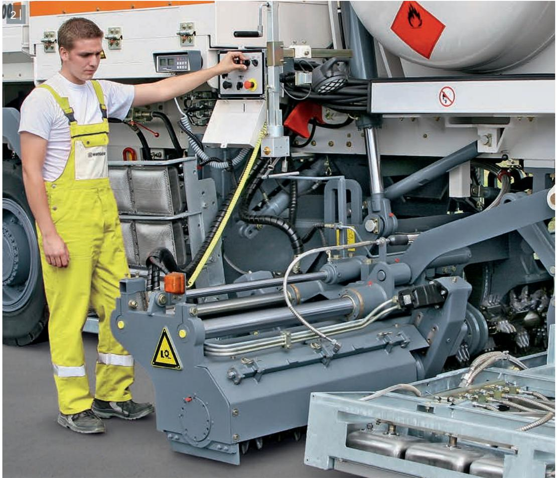
2 | Рабочая ширина разрыхлительных валов регулируется с помощью высокопрочных направляющих.
