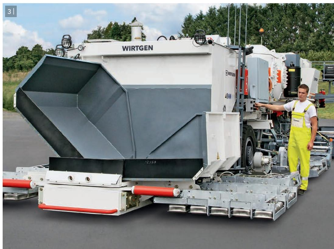
3 | Гидравлические откидные боковые стенки приемного бункера для свежей смеси.
