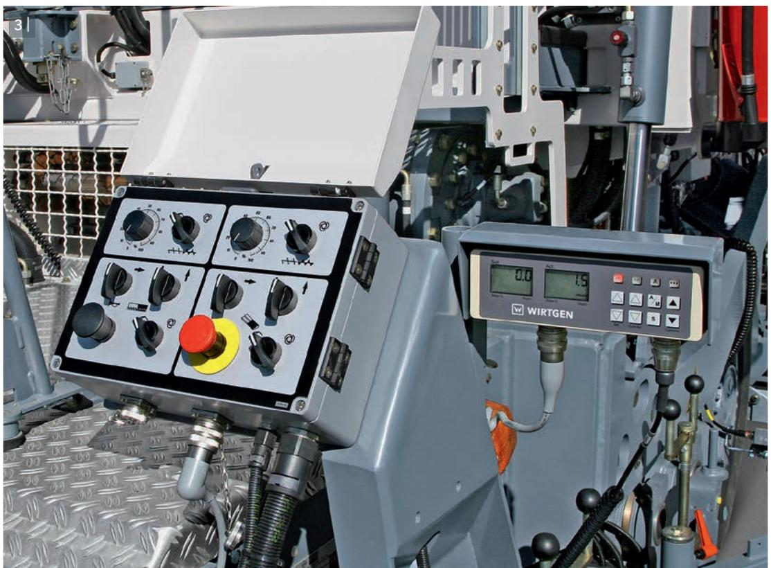
1-2 | Укладочный брус с удобным управлением одним нажатием кнопки выдвигается и снова задвигается гидравлическим способом.
