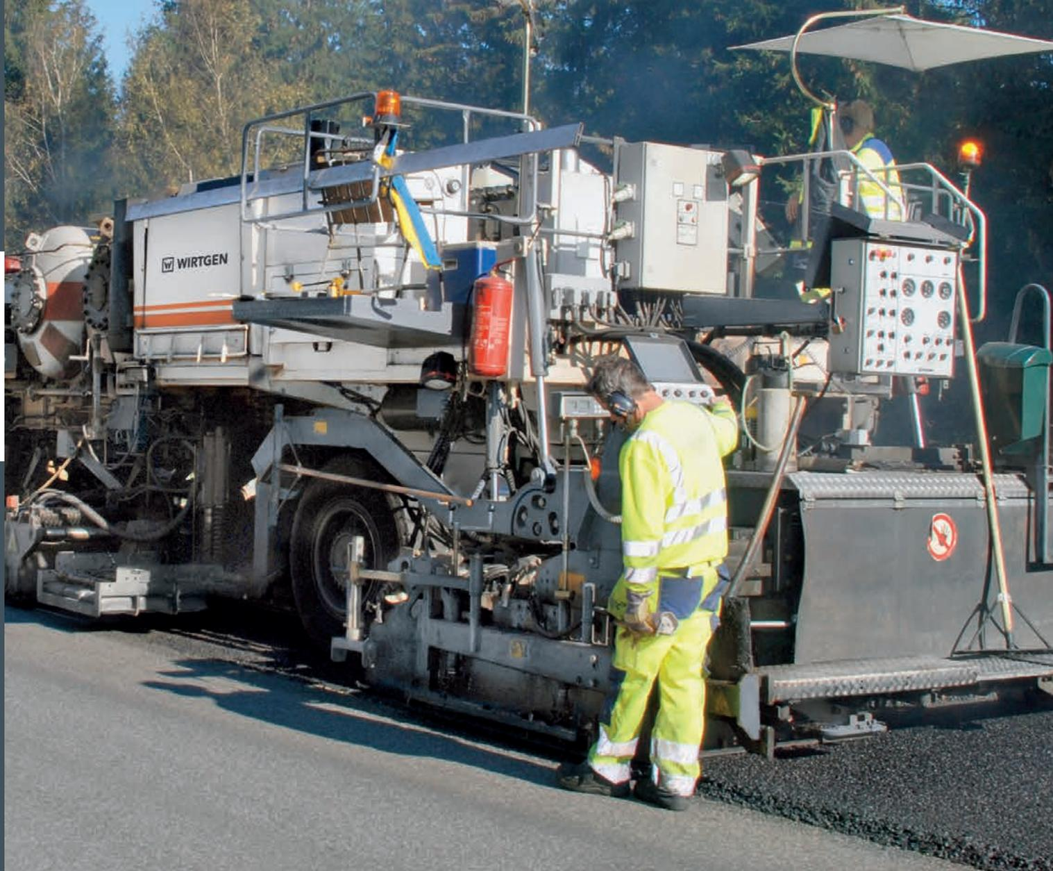
*Брусья и шнеки регулируются с помощью расположенных с обеих сторон панелей управления.*
