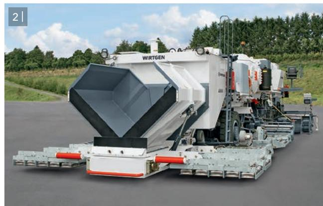
1 | Нагревательные панели открываются сегментно для гибкой регулировки рабочей ширины.
