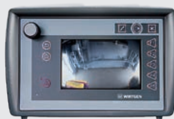
3 | Вид с зачистного щита
