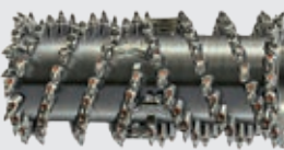
Стандартный фрезерный барабан Ширина фрезерования:: 2000 мм Глубина фрезерования: 0–330 мм Расстояние между резцами: 15 мм
