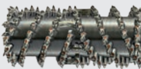
Стандартный фрезерный барабан Ширина фрезерования:: 2000 мм Глубина фрезерования: 0–330 мм Расстояние между резцами: 15 мм
