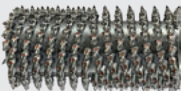
Чистовой фрезерный барабан Ширина фрезерования:: 2000 мм Глубина фрезерования: 0–100 мм Расстояние между резцами: 8 мм
