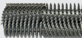
Барабан для микрофрезерования Ширина фрезерования:: 2000 мм Глубина фрезерования: 0–30 мм Расстояние между резцами: 6 x 2 мм
