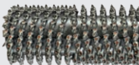
Чистовой фрезерный барабан Ширина фрезерования:: 2000 мм Глубина фрезерования: 0–100 мм Расстояние между резцами: 8 мм
