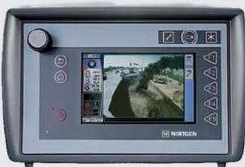
2 | Видеокamera на конце грузочного транспортера
