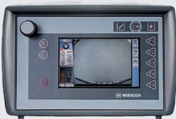
1 | Видеокamera, задняя часть машины
