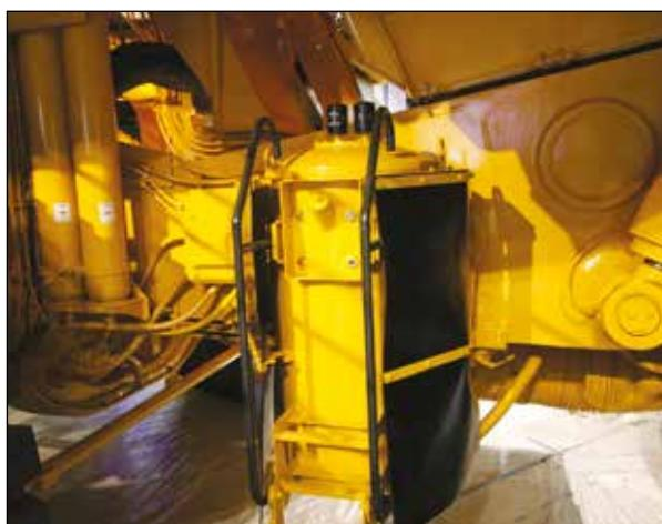
**Гидроаккумуляторы в системах рулевого управления и торможения**
