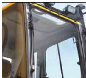
Стеклоочиститель, смонтированный на раме кабины
