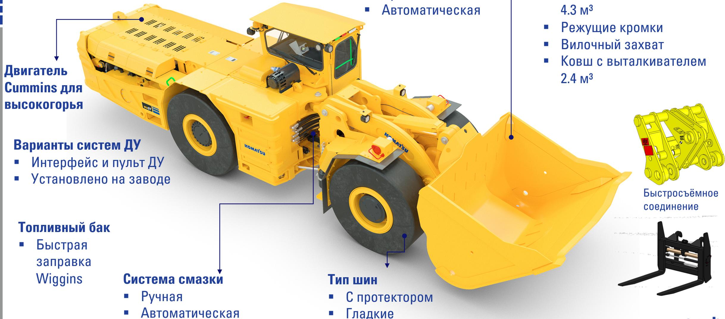
**Двигатель Cummins для высокогорья**
