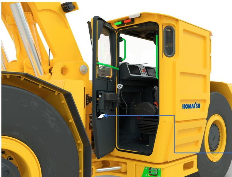
Дополнительное освещение при входе в кабину
