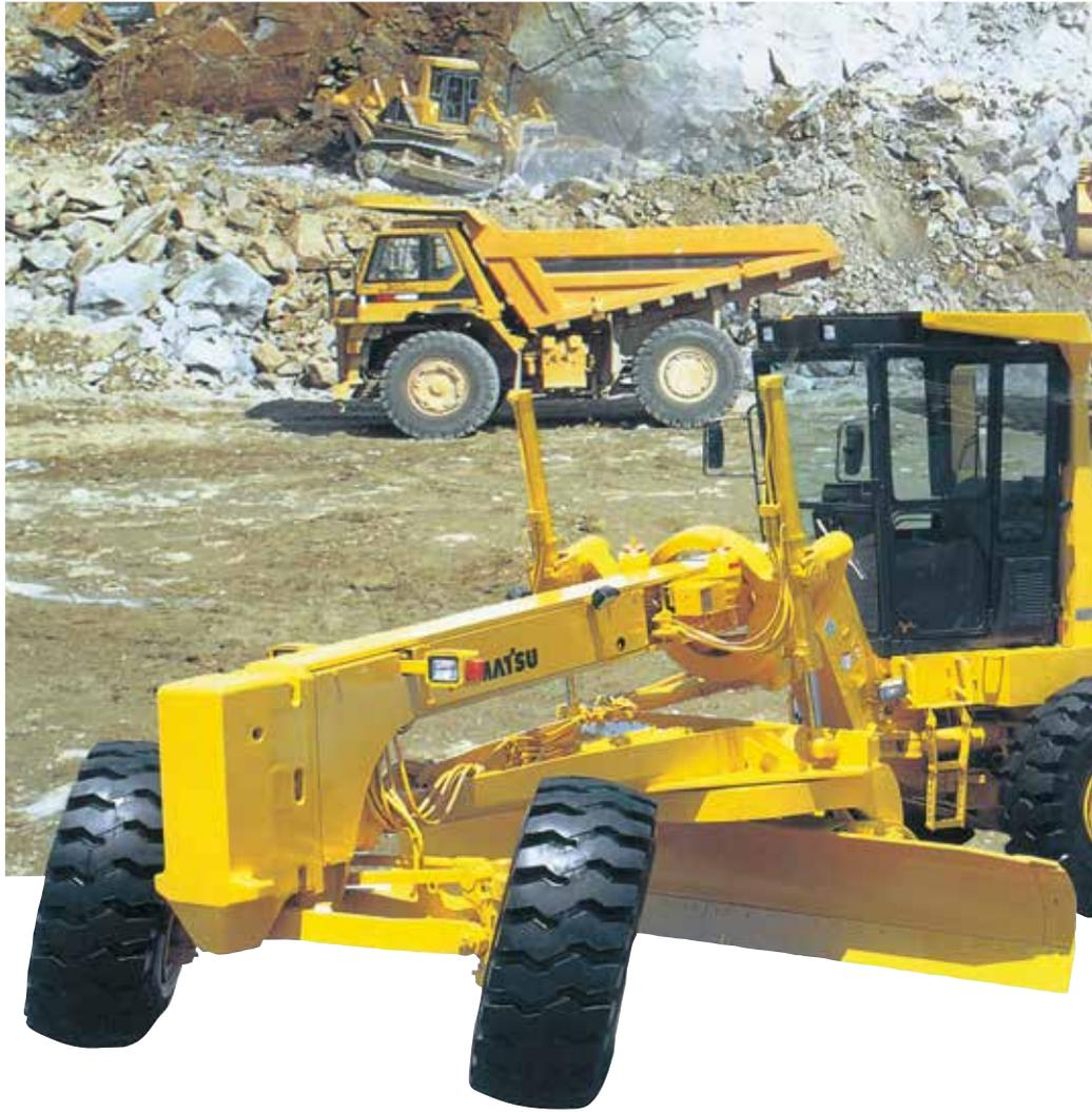
**Высокая эффективность отвала:** Оператор может, не выходя из кабины, устанавливать отвал в положение срезания откосов, доводя угол до 90 градусов с любой стороны. Высокая скорость поворота отвала ускоряет процесс изменения положения отвала для повышения производительности. Большой боковой вынос отвала и гидроривод изменения угла резания ножа отвала позволяют оператору приспособить автогрейдер GD825A-2 к работе в самых сложных условиях.
