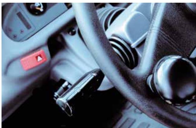
**Рулевая колонка с регулировкой наклона**
