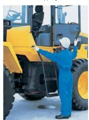
во время работы на машине с дверями, зафиксированными в открытом положении. Широкое плоское стекло, не имеющее перегородки, обеспечивает хорошую обзорность. Стеклоочистители охватывают большую площадь, обеспечивая широкий обзор даже в дождливую погоду.
