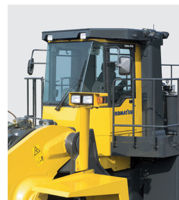
Заднее подогреваемое стекло сохраняет обзорность даже при обледенении или конденсации влаги
